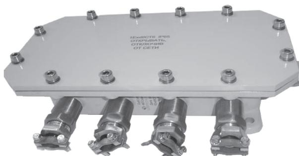
Конструкция коробки ЕхКСУВ-ПА. Прямоугольный корпус коробки закрыт крышкой, которая крепится к корпусу двенадцатью винтами. На боковых поверхностях корпуса может быть расположено до 10 кабельных вводов. Коробка крепится на стену болтами через четыре отверстия, расположенные на корпусе.
